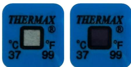
Figure 1 Surveillance de la température de transport
